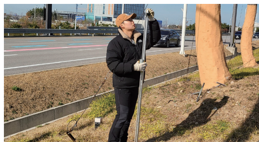
사진 2. 하세가와식 토양관입계를 이용하여 토양경도 측정.
