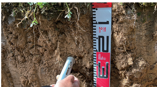
사진 1. 토양층위를 따라 산중식 토양경도계를 이용하여 토양경도 측정.
