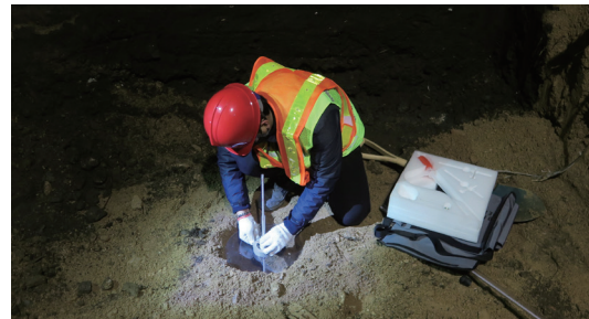
사진 4. 하세가와식 간이현장 투수시험기를 활용하여 현장에서 투수 시험.
