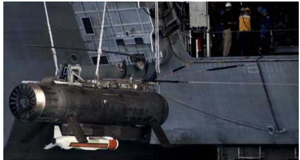
[미 해군 기뢰탐지위해 AN/AQS-20 가변심도소나를 장착한 AN/WLD-1V RMV]
